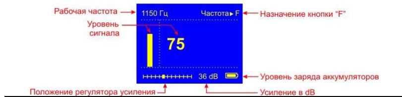
Для изменения частоты работы приемника, нажмите **F**. Выберете изменяемую цифру, нажав **F**, измените значение, нажав **▲** или **▼**. Для возврата нажмите **Ok**. Установленная частота сохраняется в энергонезависимой памяти.
