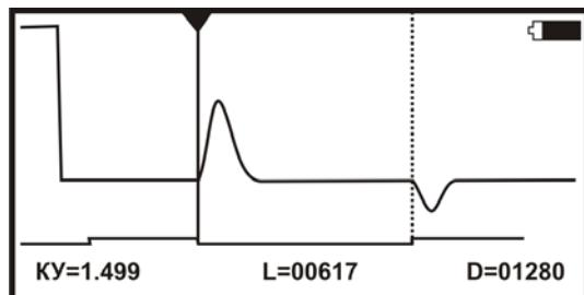
Установив курсоры, вернитесь в «карман» для кабеля. Сбросьте пункт <Измер.Укорочения> в состояние <НЕТ> кнопкой [OK]. Измеренный коэффициент укорочения будет записан в параметры кабеля.
