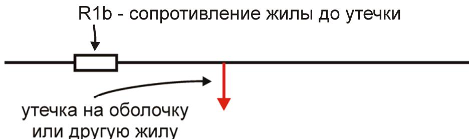
Чтобы провести измерения, необходимо включить участок с R1b в электрическую цепь. Для этого нужна неповрежденная обратная жила в кабеле:
