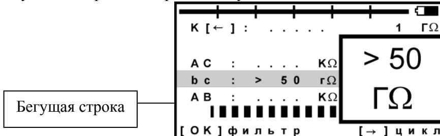
Фильтр усреднения АВТО работает по умолчанию при включении режима ИЗОЛЯЦИЯ. Он запускается автоматически: прибор постоянно перемеряет сопротивление изоляции в выбранной коммутации. В большом окне показан результат усреднения фильтра. В самой строке коммутации прибор продолжает непрерывно выводить текущие измерения.
