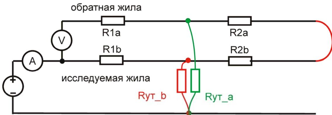
Зная соотношение  $R_{из}$  двух жил – плохой  $R_{yt\_b}$  и относительно хороший  $R_{yt\_a}$  – можно определить место повреждения обычным мостовым методом. Для этого перед измерением  $R_{1b}$  на холостом ходу необходимо измерить коэффициент  $K$ , отражающий отношение  $R_{из}$  двух жил:
