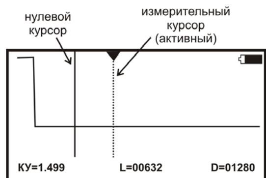
При нажатии кнопки [КАРТА] прибор покажет кабель полностью. Повторное нажатие приведет к восстановлению установленной растяжки вокруг активного курсора. Вы можете то просмотреть кабель целиком, то только область растяжки. В режиме КАРТА прибор выводит карту кабеля, и экран принимает вид, показанный на рисунке.
