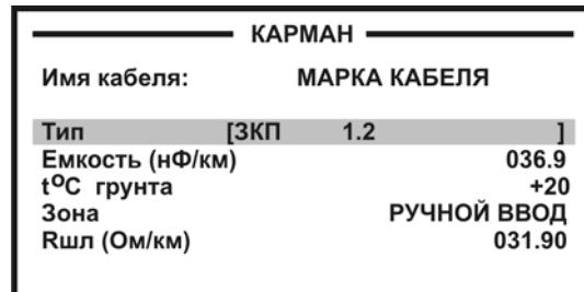
Включите режим ЕМКОСТЬ. Измерьте емкость оборванной ПАРЫ (не жилы!) с помощью фильтра – [OK]. Прибор автоматически рассчитает расстояние до обрыва по погонной емкости кабеля и выведет результат в верхней части экрана.
