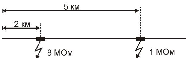
Все мосты постоянного тока устроены так, что определяют одно повреждение. Два повреждения, накладываясь друг на друга, дают смешанную картину.
