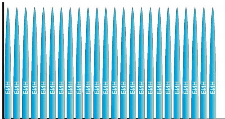
Общее количество бинов составляет 256 для ADSL и ADSL2 и 512 – для ADSL2+. Бины нумеруются, начиная с нуля. Бин №0 в цифровой передаче не используется и резервируется для голосовой связи. Последние бины также не используются. Остальные – распределяются в зависимости от решаемых задач. Часть отводится для
