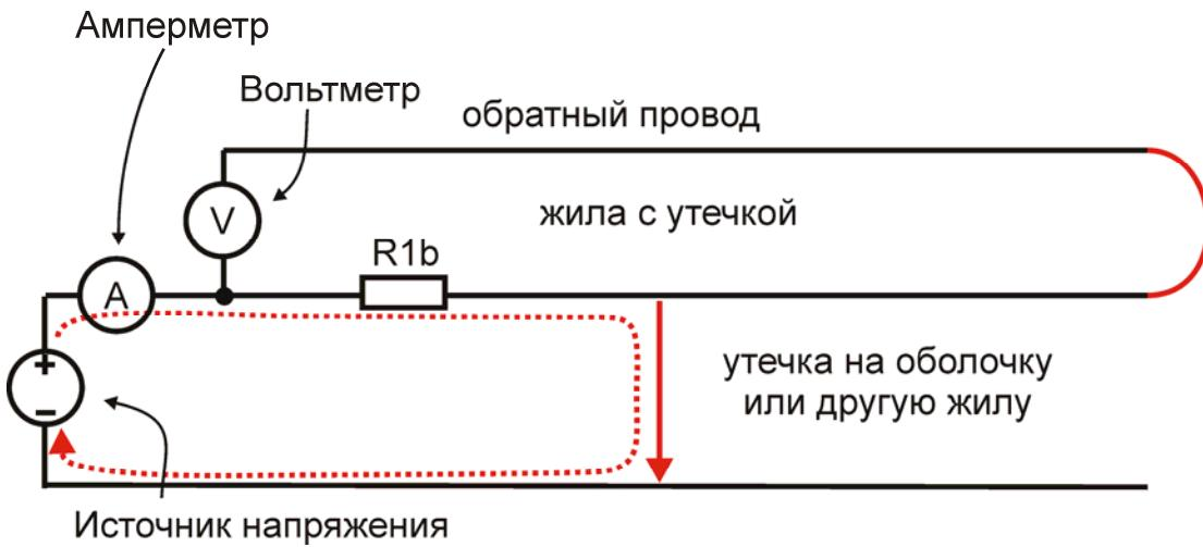
Обратная жила играет роль измерительного провода вольтметра для измерения падения напряжения  $V$  на участке с  $R1b$ . По закону Ома
