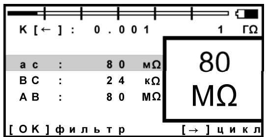
2. Включают режим ШЛЕЙФ, замыкают шлейф на дальнем конце между плохой и хорошей жилами. По показаниям прибора контролируют качество соединения на дальнем конце. После выполнения соединения кнопкой [OK] запускают измерение шлейфа фильтром. Работа фильтра обязательна!
