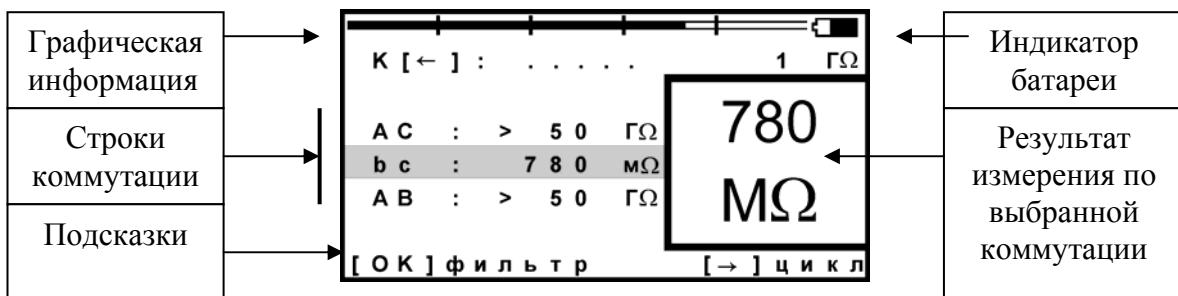
На экран выведены три строки коммутации, которые показывают результат измерения между проводами АС, ВС и АВ. Кнопками  $\blacktriangle \nabla$  измеритель выбирает нужную коммутацию. В выбранной строке прибор непрерывно проводит измерения между обозначенными проводами и одновременно показывает их в большом окне для удобства чтения.
