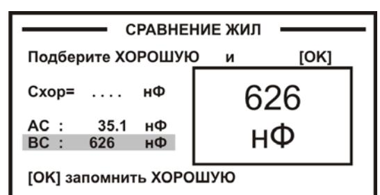
Прибор проведет измерение емкости жилы, которая принимается за эталонную и сравнит с ней емкость оборванной жилы. На приведенном рисунке хорошая жила В имеет емкость по отношению к оболочке 626 нФ. Прибор показал, что он выбрал ее за эталон «С хор» и сравнил с ней емкость оборванной жилы А. Результат показан в процентах длины или метрах, если длина введена.
