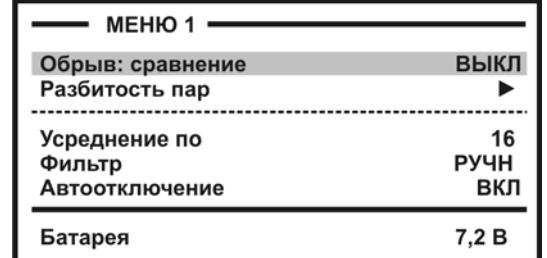
Подключите оборванную жилу и хорошую к измерительным проводам А и В. Провод С подключите к оболочке кабеля. Выбрав режим <сравнение жил>, нажмите [OK]. Прибор включит измерительный экран и предложит выбрать хорошую жилу из двух измеренных. Хорошая жила та, у которой емкость больше. Копками ▲▼ выделите строку с хорошей жилой и нажмите [OK].
