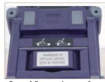
Рисунок 6: Вид верхней части прибора с отображением электрических и оптических интерфейсов.
