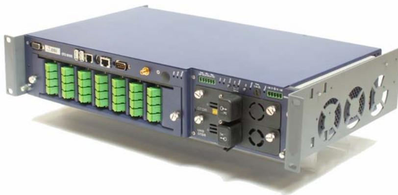
**Система непрерывного мониторинга оптических волокон позволяет оперативно локализовать неполадки и деградации волокна.**
