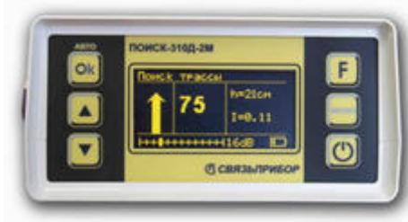
Проверку отбора производят в режиме генератора «ВЧ» или «ВЧ-ПАУЗА» (2 187,5 Гц), переключив приемник в режим «ПОИСК ТРАССЫ». Далее необходимо зафиксировать направление сигнала на отобранном кабеле кнопкой «F». При переключении отборника на любой соседний кабель сигнал меняет направление на обратное и величина сигнала уменьшается.
