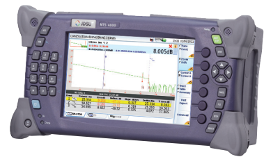
Двухслотовая модульная платформа для тестирования медных и оптических линий связи
